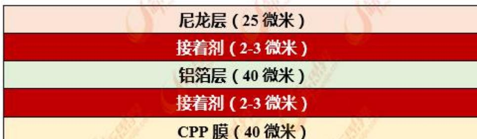
昭和铝塑膜的优点有：成本低，供货速度快；外观光滑平整，无沙眼、褶皱；冲深性能好，能满足大部分聚合物锂离子电芯的要求（匹配昭和冲深设备冲深可达 8~10mm）；热封性能；在适当温度、压力、时间条件下，昭和铝塑膜封接强度、封接绝缘性、密封性远优于同类产品；耐电解液性能，昭和铝塑膜内层为高纯度 CPP，具有良好的耐电解液腐蚀的性能。
